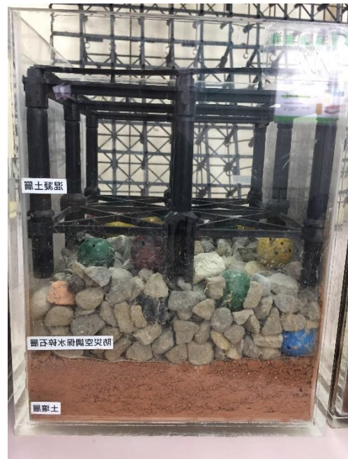
圖十三、 JW 工法逐層結構
