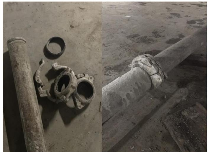
灌漿管每節通常3m，橡皮套加鐵環接合
