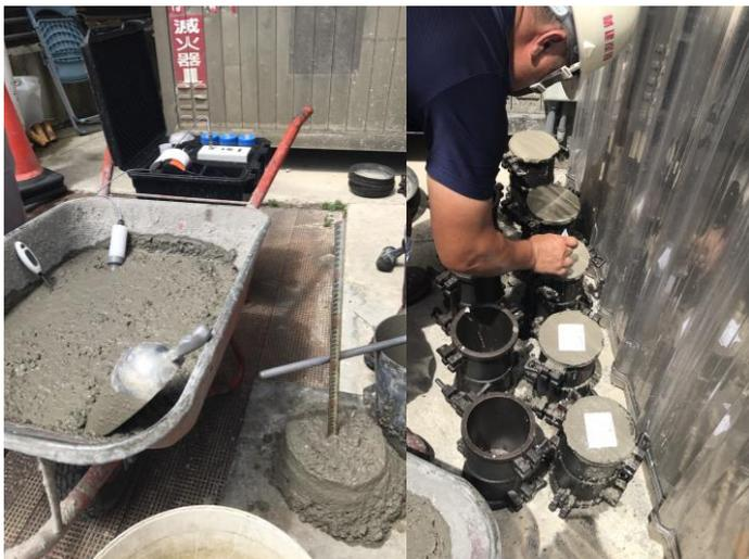
抽測溫度、坍流度、氯離子及抗壓試體
